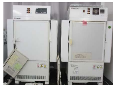
左が新しい人工気象器。LEDランプ、温度・時間設定がデジタルです。右が既存の人工気象器。まだまだ現役で使えます。
