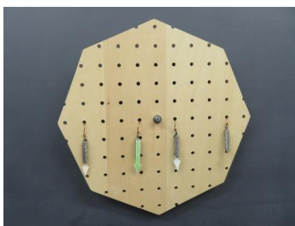
宇於崎教諭の自作教材「力のモーメント実験器」による説明
