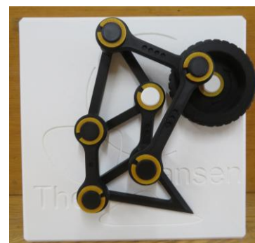
宇於崎教諭が 3D プリンターで作成したヤンセン機構
